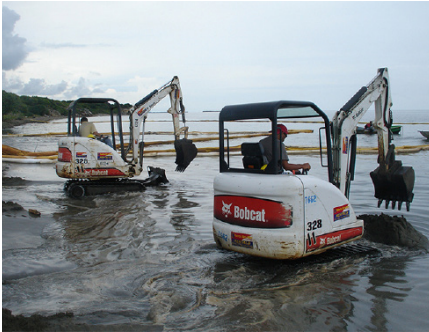
تجميع النفط باستعمال حفارة هيدروليكية المرجع (response.restoration.noaa.gov)
